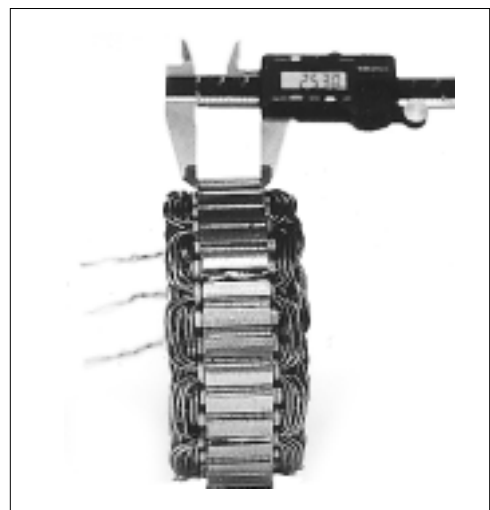
Hauteur totale de la carcasse de métal du stator. Total thickness of the stator core.
